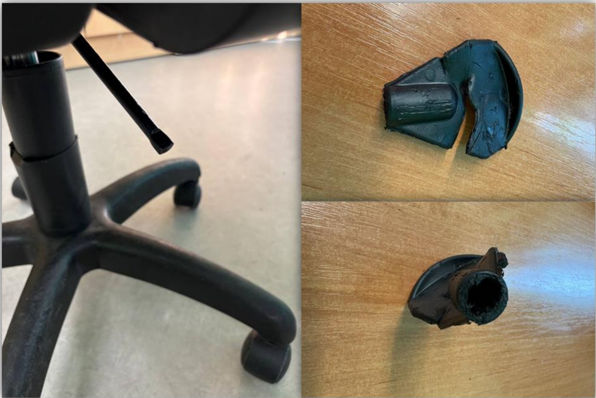
Рис. 3. Дефекты и поломки рукояти рычага подъёмного механизма
